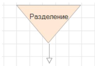
Рисунок 132 — Графический элемент Разделение
